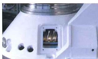
テーブル駆動部、ダブルウォームシステム採用 (HB306)
