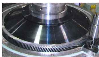
テーブル駆動部、大径ヘリカルギヤ採用 (HB086/156)
