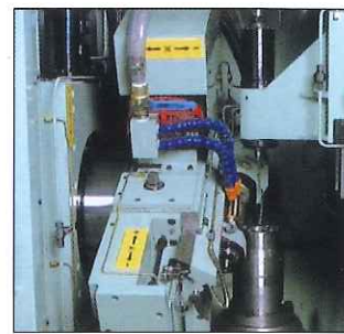
クイル移動構造 Quill slide independent hob head
