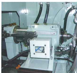
ワークセンタークイル方式 (オプション) Quill type tail stock (option)
